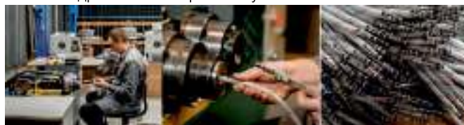
Гильзы на концах шланга обжимаются на гидравлическом прессе с кулачковым механизмом
